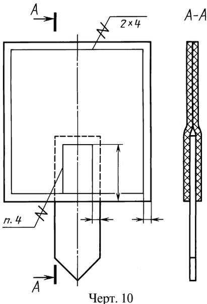
3.1. Соединения, получаемые сшиванием, следует изображать на чертежах тонкой сплошной линией и обозначать условным знаком, выполненным сплошной основной линией и нанесенным на линии-выноске (черт. 10).
