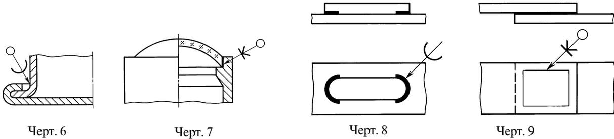
2.6. Обозначение припоя или клея (клеящего вещества) по соответствующему стандарту или техническим условиям следует приводить в технических требованиях чертежа записью по типу: «ПОС 40 ГОСТ...» или «Клей БФ-2 ГОСТ...».
